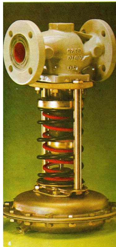
شیر تنظیم فشار برای بخار، مایعات و گازهای غیر قابل استعال 3-145 psi
