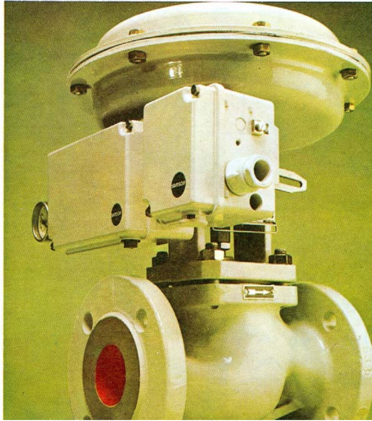
نمونه‌ای از شیر خودکار و دستگاه موقعیت دهنده Valve Positioner
